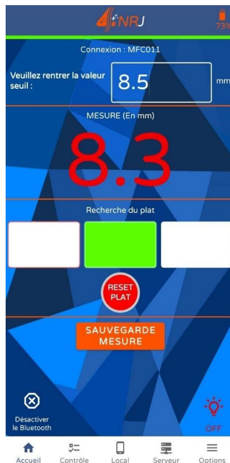
Epaisseur du fil inférieur à la valeur seuil
