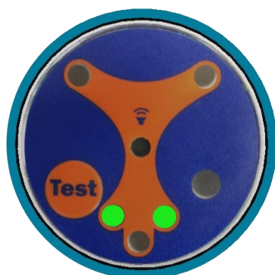
Absence de tension
