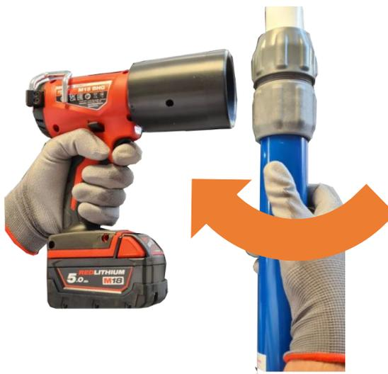
3. Pour desserrer les manchons plus facilement, des clés sont fournies dans la sacoche. Insérer la clé correspondante au diamètre du manchon et desserrer l'écrou qui était bloqué.
