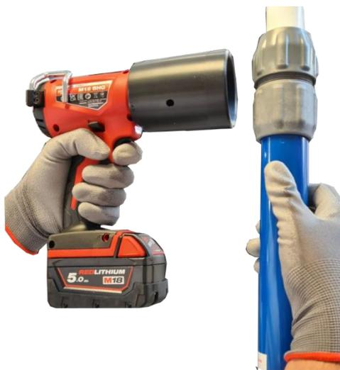
2. Effectuer une rotation de la perche à 90°, afin de ne pas surchauffer la partie du manchon et que par conséquent que la matière fonde. Répéter l'opération toutes les 10 à 15 secondes durant 1 à 2 minutes maximum.
