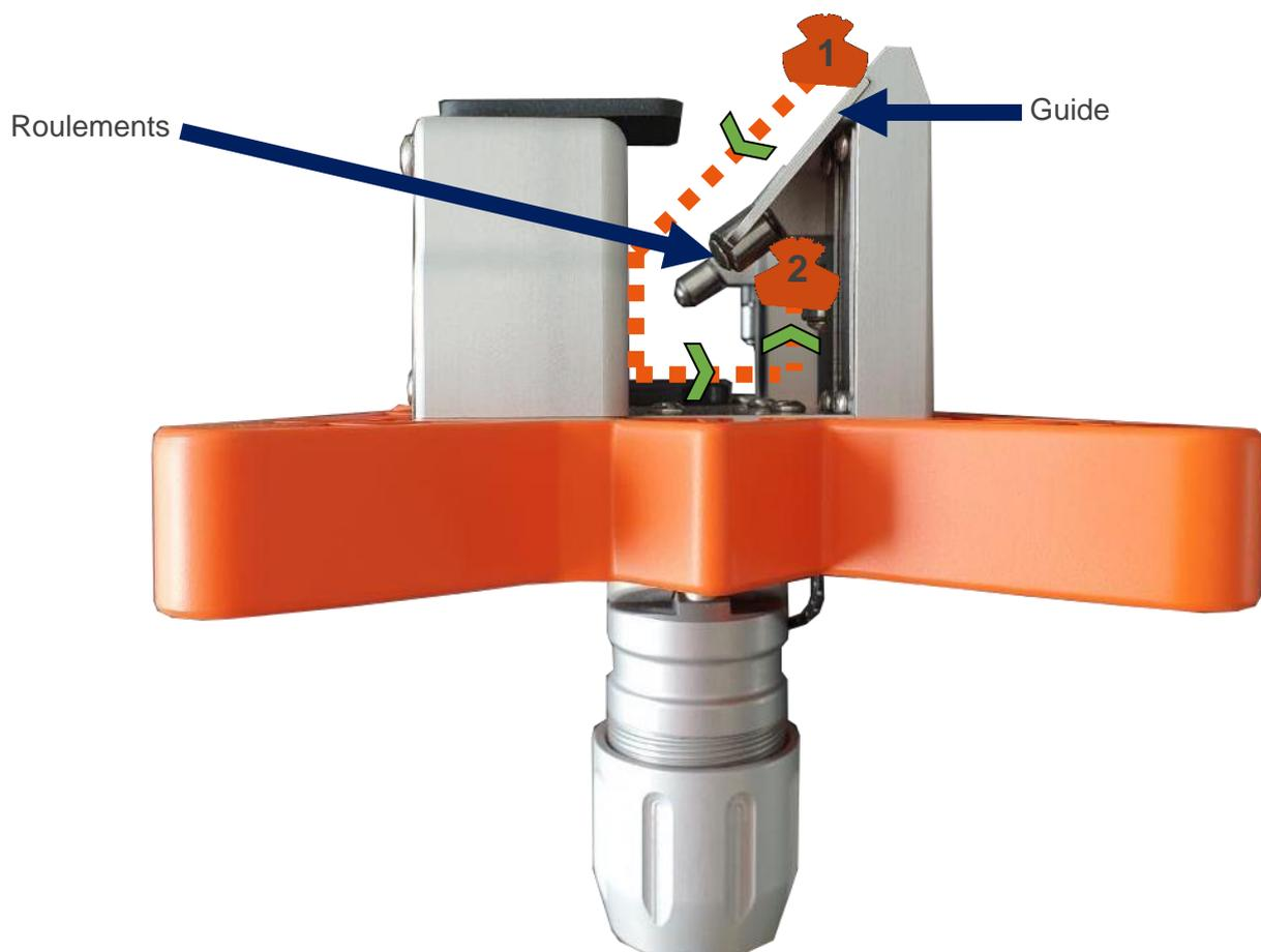
**!** Lorsque l'appareil est correctement positionné sur le fil de contact, celui-ci doit pouvoir rouler sur le fil de contact.
