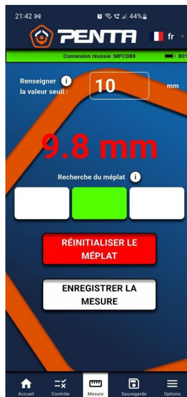
Epaisseur du fil inférieur à la valeur seuil
