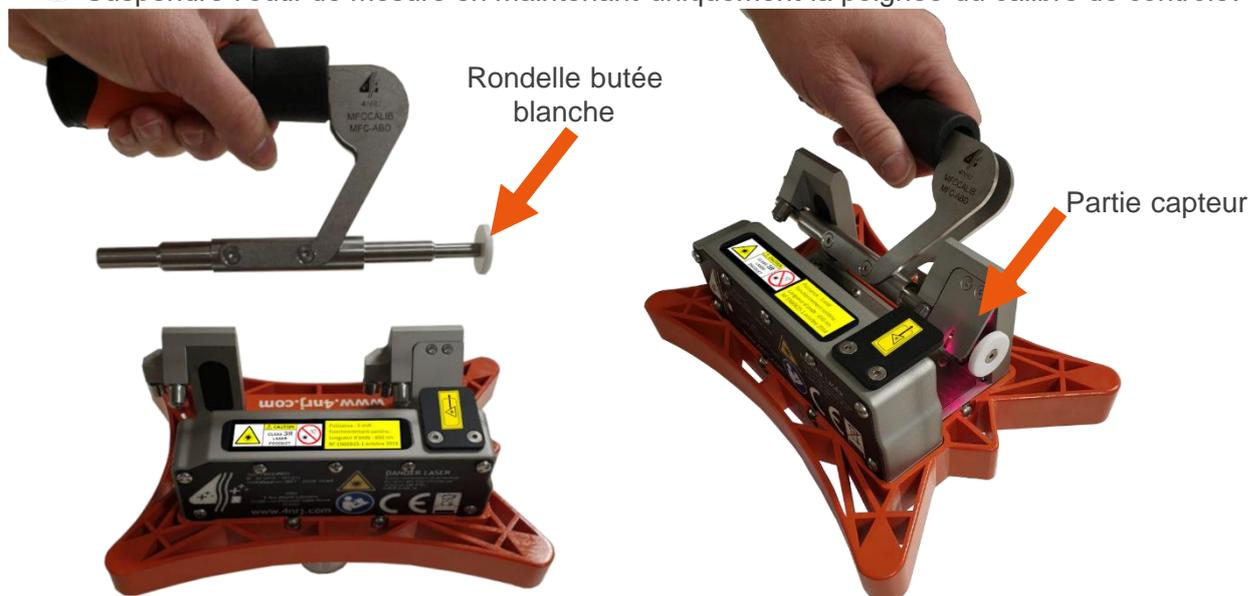
B. Appuyer sur le bouton « CONTRÔLE » et visualiser le résultat.
