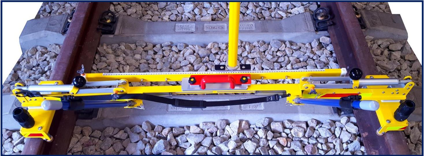
2. Déplacer sans forcer le mat de mesure de droite à gauche en visant à l'aide du DISTO.
